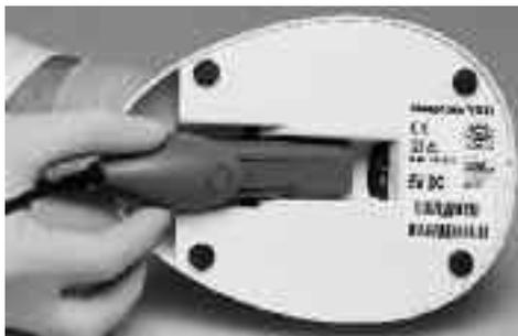
Для этого необходимо вынуть аккумулятор из наконечника. После этого отсоединить штекер сетевого блока питания с нижней стороны зарядного блока. При этом не следует тянуть за сетевой кабель.
