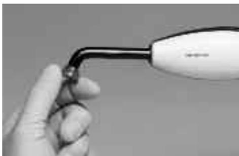
Затем установить на световод защитный экран.
