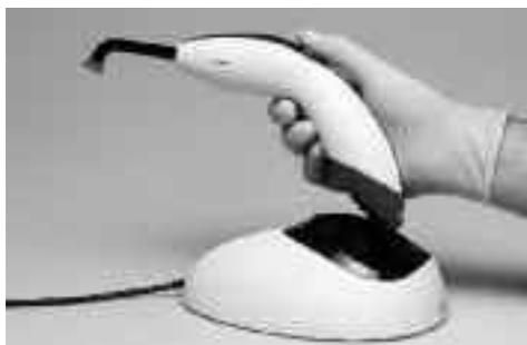
Delikatnie umieścić rękojeść w otworze podstawy-ładowarki. Jeśli używana jest jednorazowa osłonka ochronna, należy ją zdjąć przed ładowaniem. W miarę możliwości należy zawsze używać lampy z całkowicie naładowanym akumulatorem. Zapewnia to przedłużenie jej żywotności. Z tego względu zalecane jest odkładanie rękojści na podstawę – ładowarkę po wizycie każdego pacjenta. W przypadku rozładowanego akumulatora, ładowanie trwa ok. 2 godzin.
