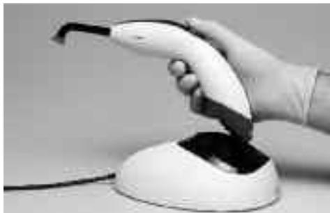
Не применяя усилие, вставить наконечник в отверстие на зарядном блоке. Если применяется гигиеническая защита, ее следует удалить перед зарядкой аккумулятора.
